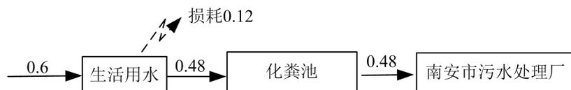
**图 2-1 项目水平衡图 (t/d)**
