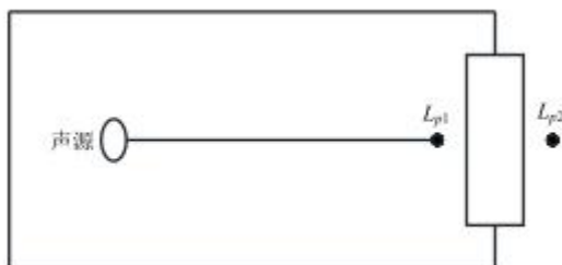
图4-2 室内声源等效为室外声源图例
